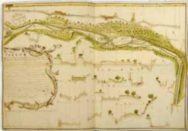
Corso del fiume di Serravezza dalla confluenza “col Canale di Solaio”, nei pressi di Vallecchia fino al “Ponte Rosso”. Si notano le sezioni dell’alveo e del “letto del vecchio fiume morto” che prima della deviazione raggiungeva lo scalo e fortezza di Motrone.
